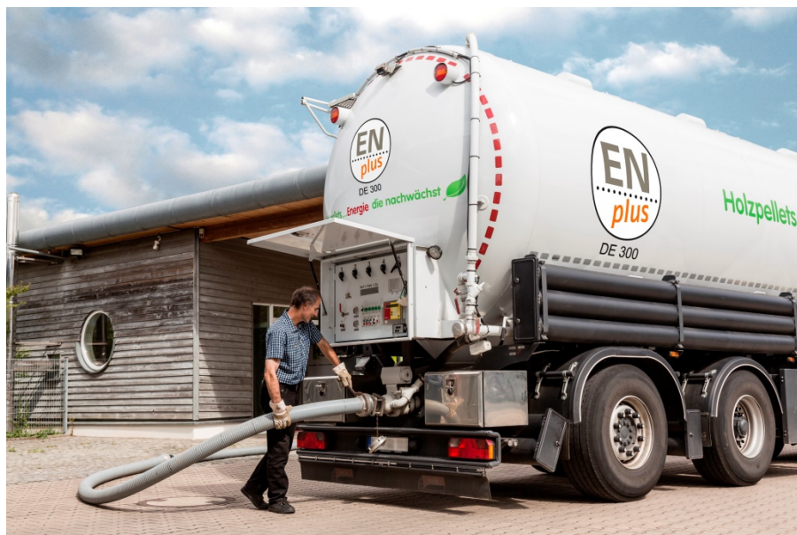
Fig. 2. Camión cisterna con sistema de descarga neumático (Foto DEPI)
