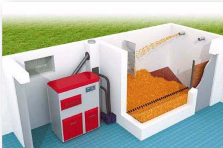
Fig. 12. Silo de obra con suelo inclinado de un lado
