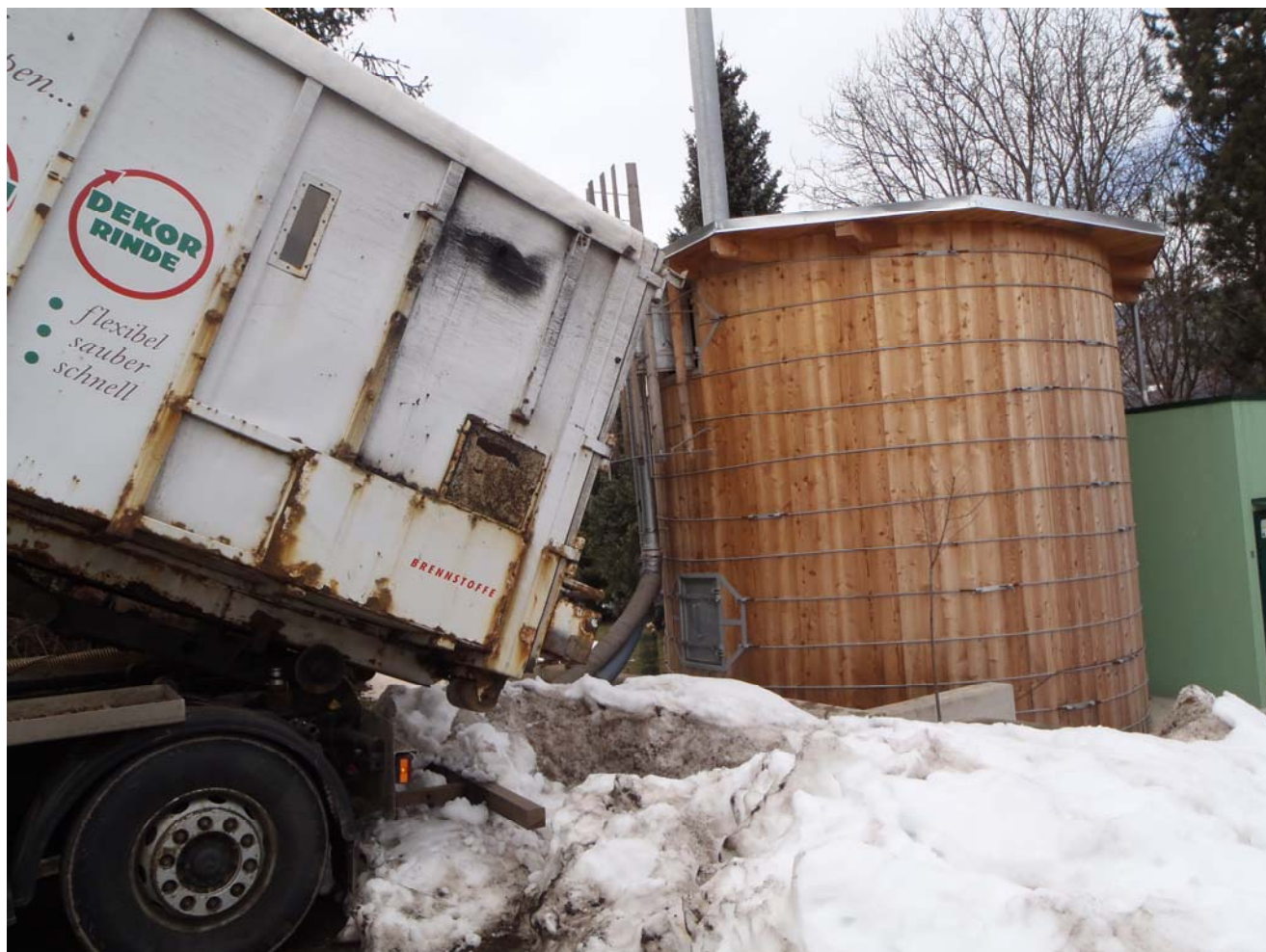
Fig. 4. Camión con alimentador rotatorio realizando una descarga en un silo de pellets (foto AVEBIOM)
