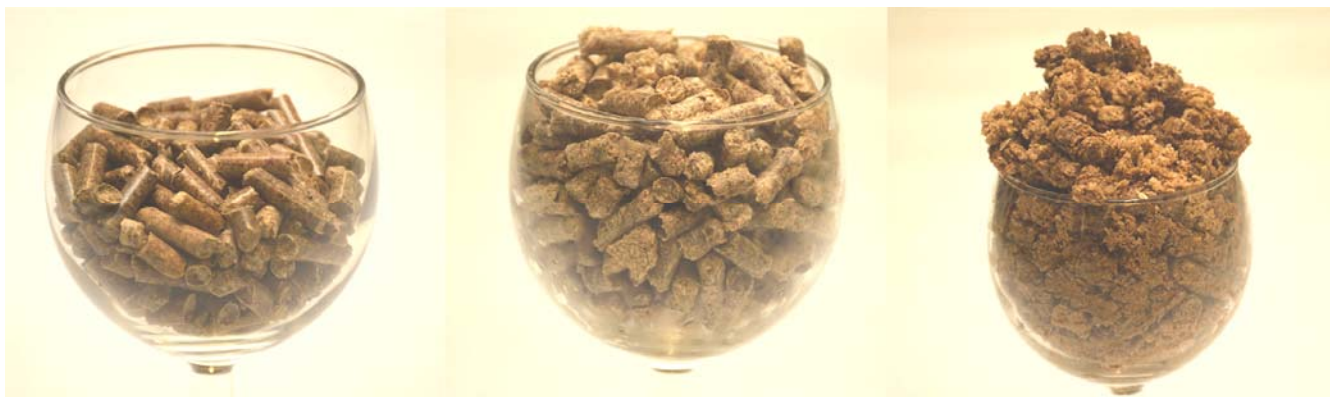
Fig. 5. Pellets secos (izq.) pellets algo afectados por humedad (centro) pellets en mal estado por humedad (derecha). Foto: AVEBIOM
